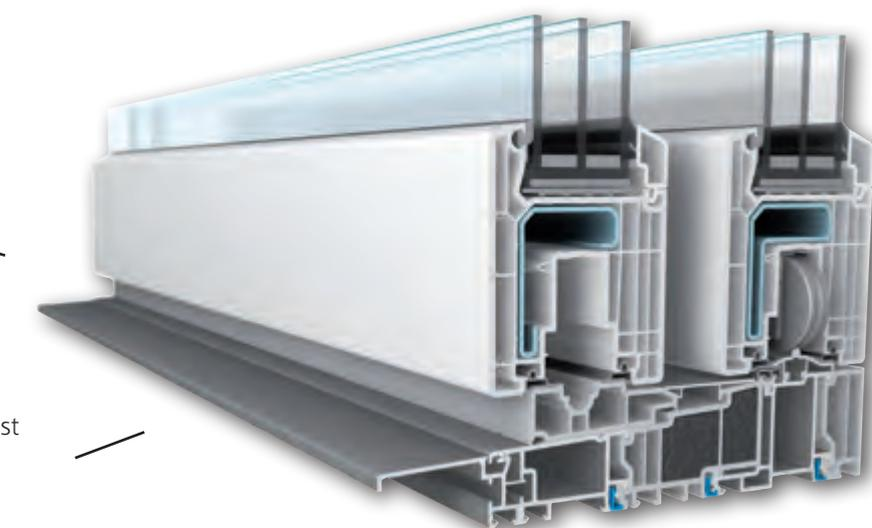
Nově vyvinutý práh s integrovanou tepelnou vložkou a dvakrát přerušeným tepelným mostem vykazuje vynikající tepelně izolační hodnoty a eliminuje studené zóny v podlaze.
